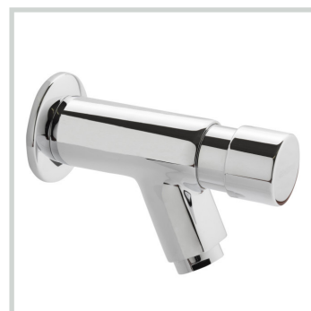
COD. 1037-04 Grifo temporizado lavabo para instalar en pared 7-10 seg. dota- do de aireador antical economizador
